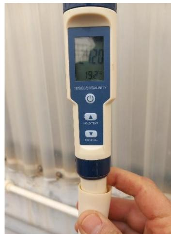
**Analyse de la conductibilité électrique (EC)**
