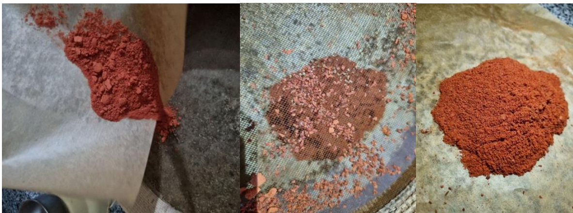
Figure 11: Tamissage de la poudre
