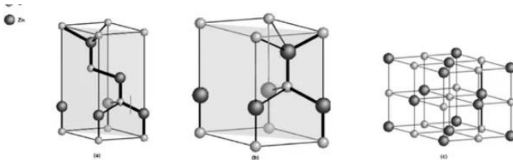
Figure 4 : modèle de structure cristalline de l'oxyde de zinc (a) de la blende de zinc (b) de la wurtzite (c) du sel gemme (Zhou, 2023).
