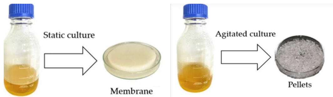
Figure 3 : les différents milieux de culture pour la fabrication de la cellulose bactérienne ( Potočnik, 2023 ).
