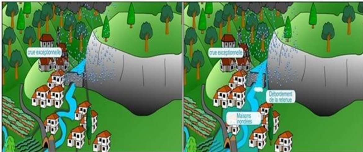
Fig. I.8. Inondation par débordement au-dessus de la digue ( (Ledoux., 2006)).
