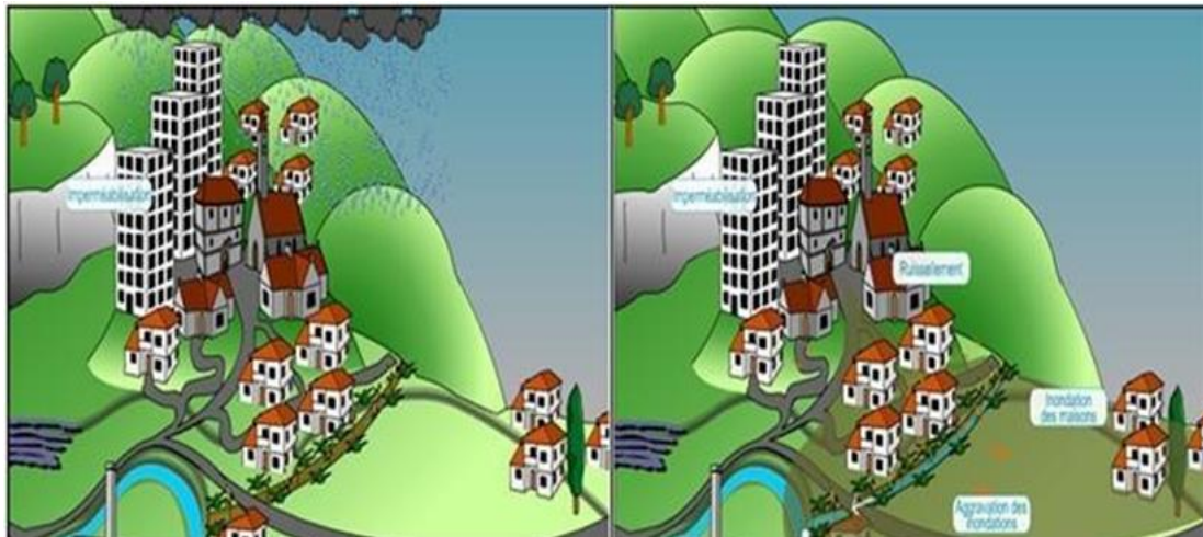
Fig. I.7. Inondation par ruissellement en secteur urbain (Ledoux., 2006)
