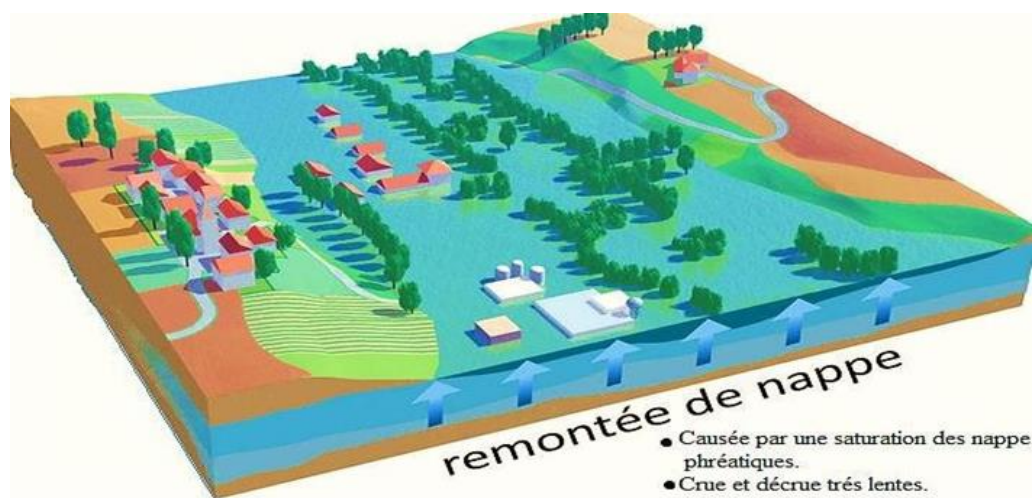
Fig. I.4. Inondation de Plaine. ( Ledoux, 2006).
