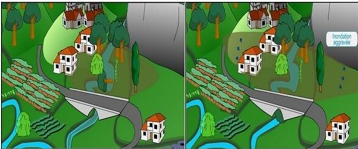
Fig. I.9. Inondation par débordement au-dessus de la digue ( (Ledoux., 2006)
