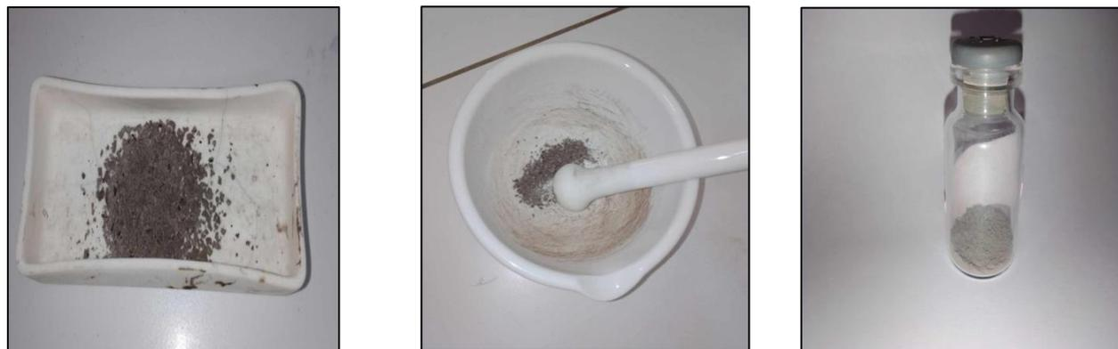
**Figure 19:** les nanoparticules après calcination.
