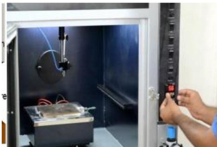
*Figure II.5 : Instrument à élaboration des couches minces méthode «spray ».*
