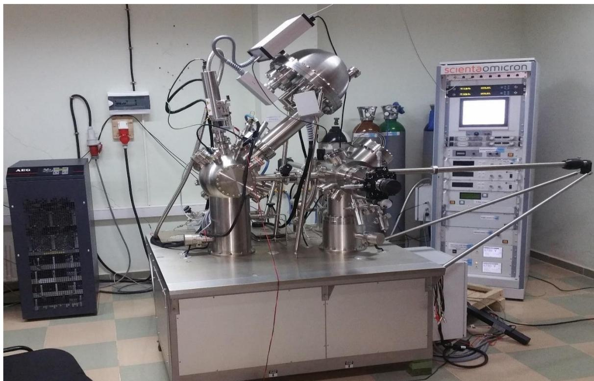
*Figure II.9 : Bâti expérimental (AES, EELS, XPS, UPS).*
