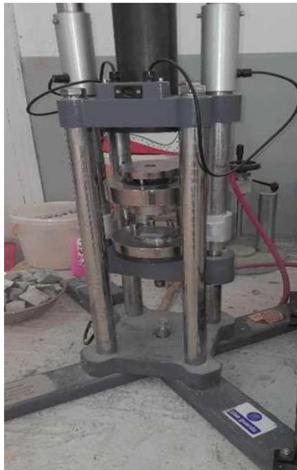
**Figure 24: Appareil de l'essai de la compression**
