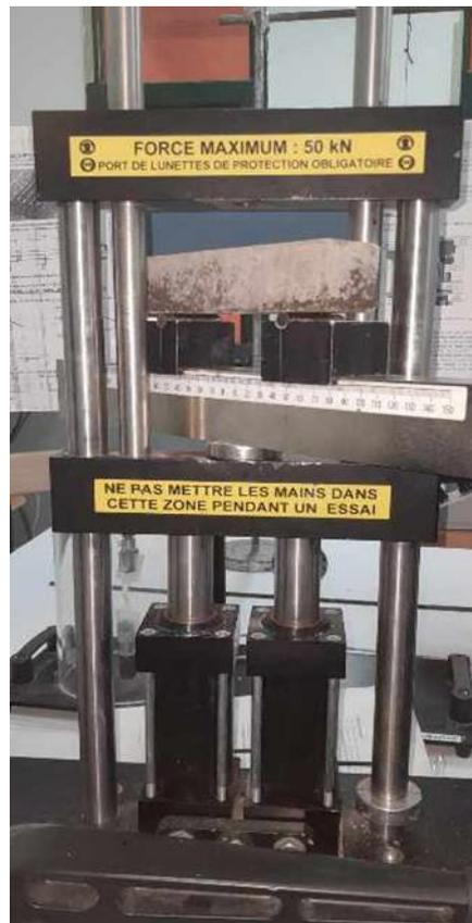
Figure 22: Appareil de l'essai de la flexion
