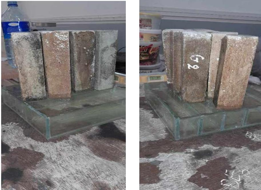
Figure 28: Essai d'absorption capillaire
