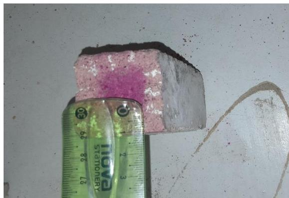
Figure 31: Carbonatation des éprouvettes
