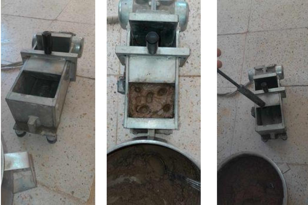
Figure 20: quelque photos sur l'essai de maniabilité
