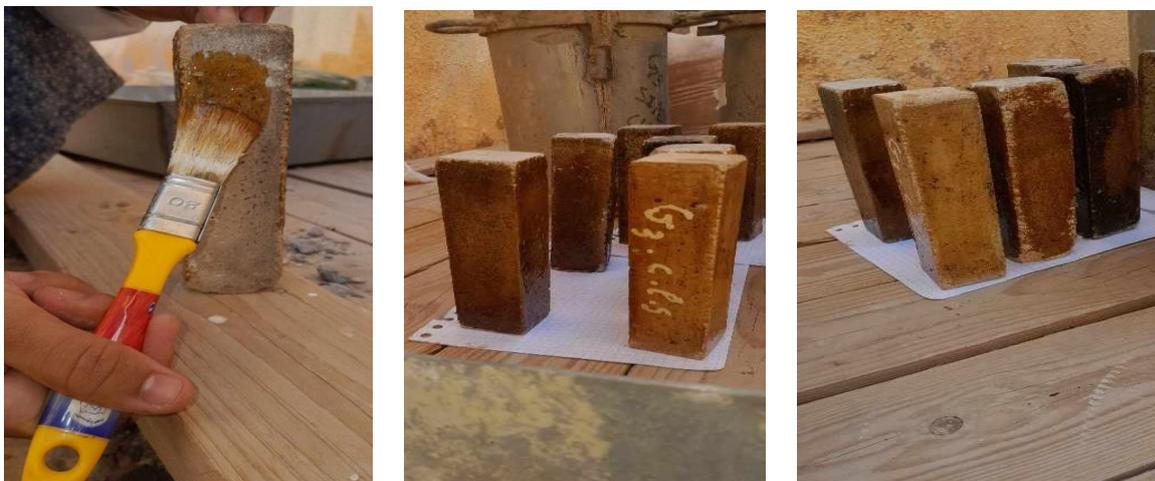
**Figure 27: quelques photos lorsqu'on a fait la résine sur éprouvette**
