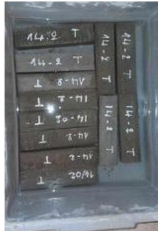
**Figure 17: Préparation de mortier simple(témoin)**
