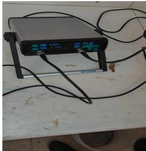
Figure 32: Appareil à ultrasons type Pundit Lab +
