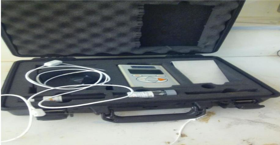
Figure 36: Appareil de mesure conductivité thermique
