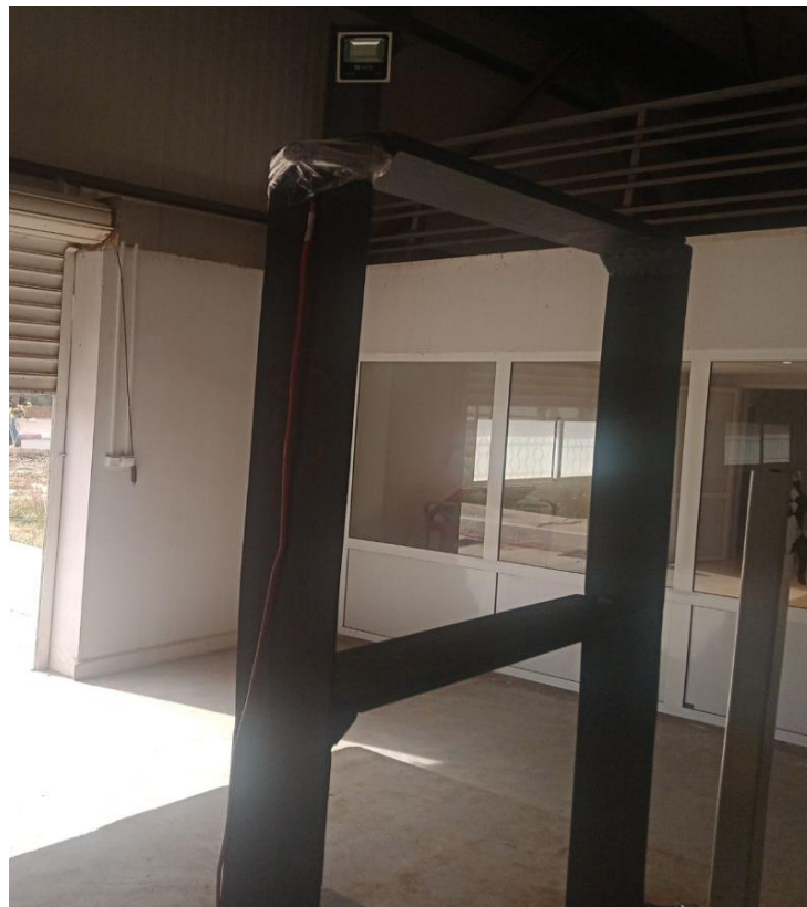
Figure 4.19 : Emplacement de l'accéléromètre au 3 ème niveau.
