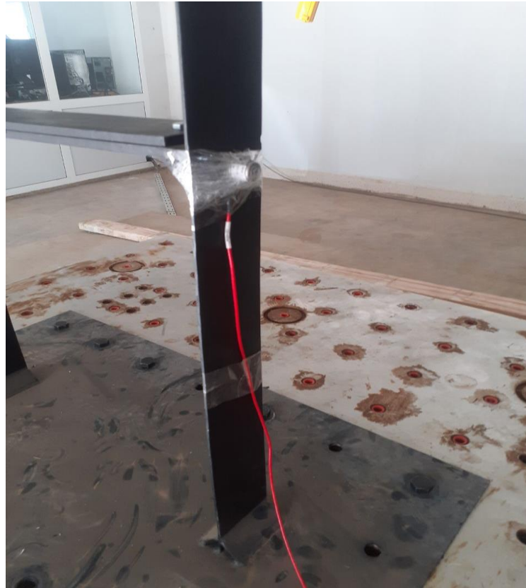
Figure 4.15 : Emplacement de l'accéléromètre au 1 er niveau.
