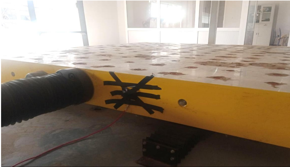
Figure 4.12 : Position de l'accéléromètre sur la table vibrante.
