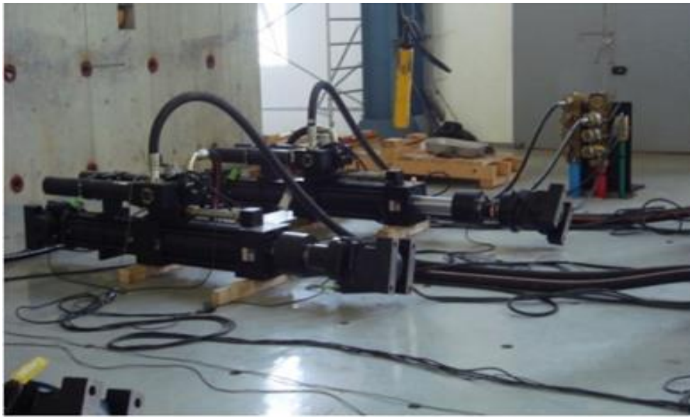
Figure 2.18 : Vérins hydrauliques du système d'essai de structure [38].
