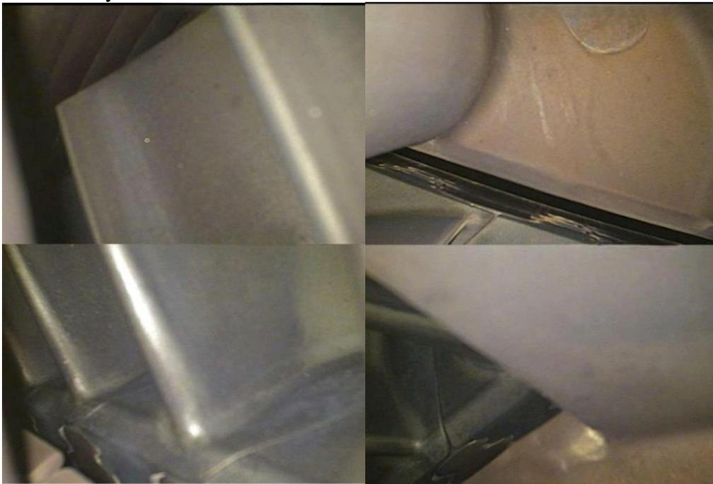
Figure IV.24 : Trois<sup>ème</sup> aube et buse de turbine [72].
