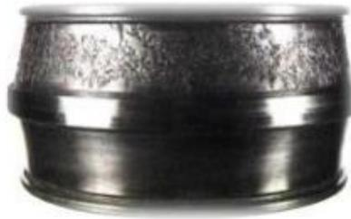
**FIGURE II.25: DEFAUT DE ROULEMENT – ECAILLAGE. [59]**
