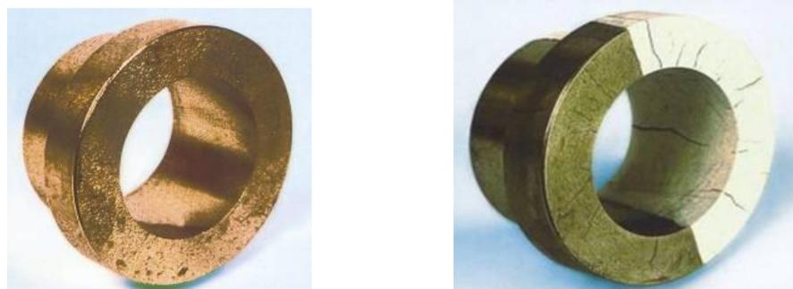
Figure III.14 : Exemple d'une pièce avant (à gauche) et après (à droite) le contrôle par rassage. [61]
