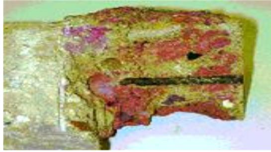
**Figure I.1:** Carbonation du béton. [4]
