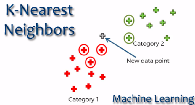
Figure 23 : Principe de l'algorithme KNN
