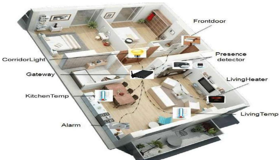
Figure 1.2 : maison intelligente connecté via une passerelle centralisée [9]
