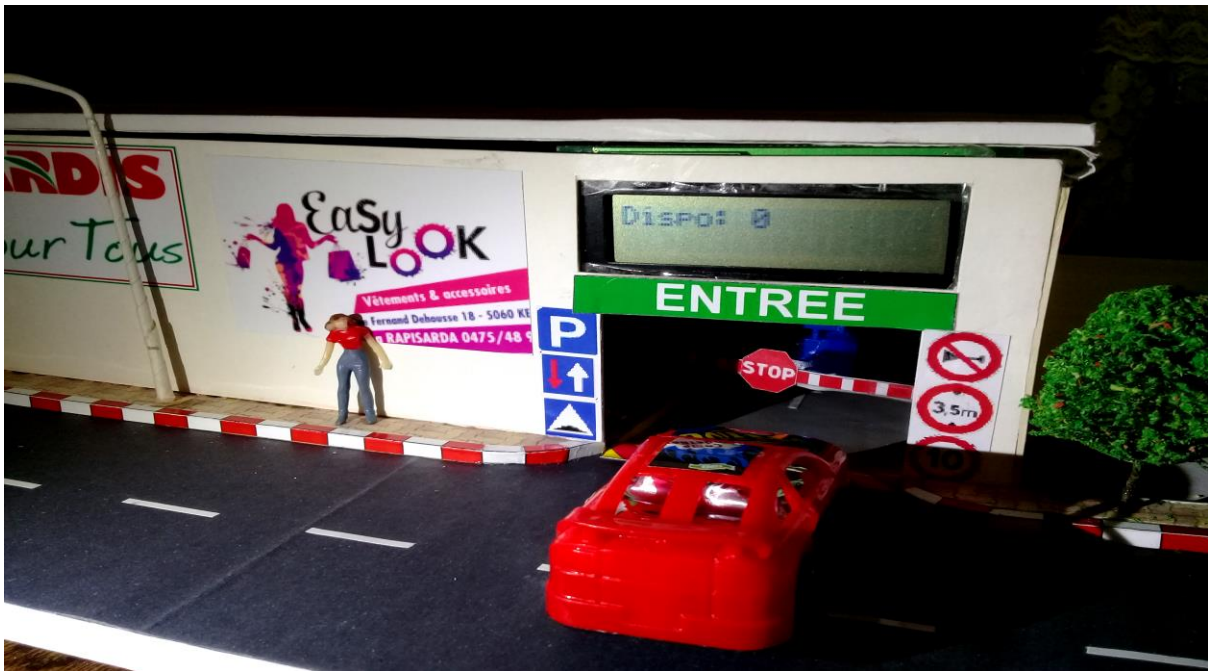
Figure III.9 : La disponibilité d'aucune place dans le parking
