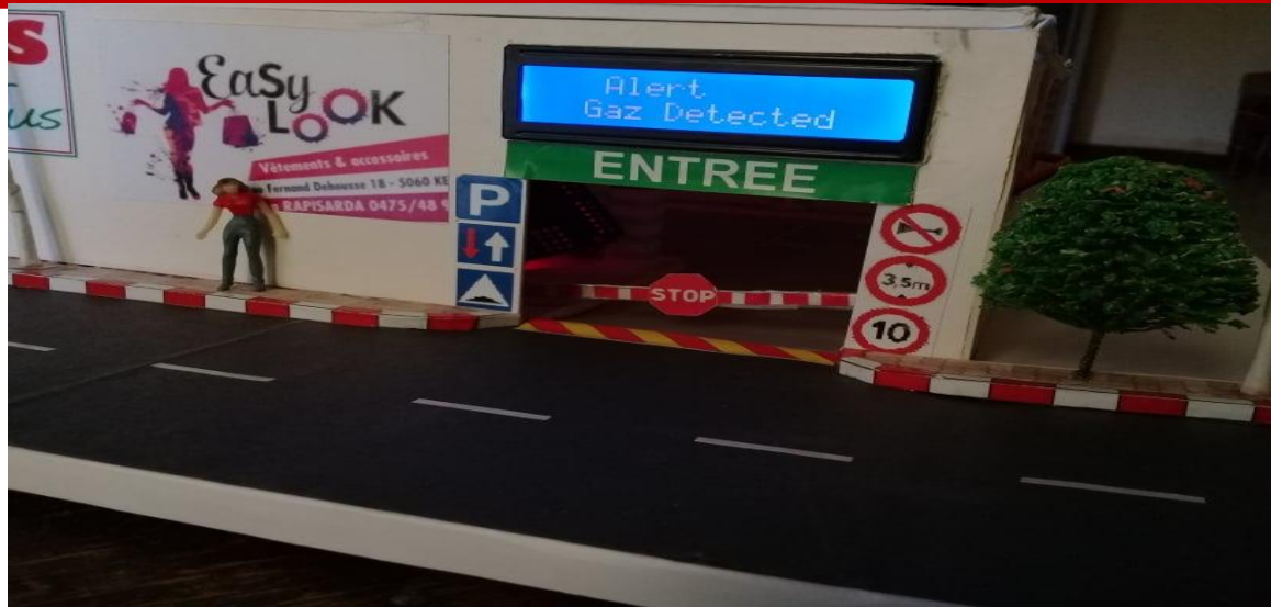
Figure III. 15. Affichage d'une alerte au cas de détection de gaz
