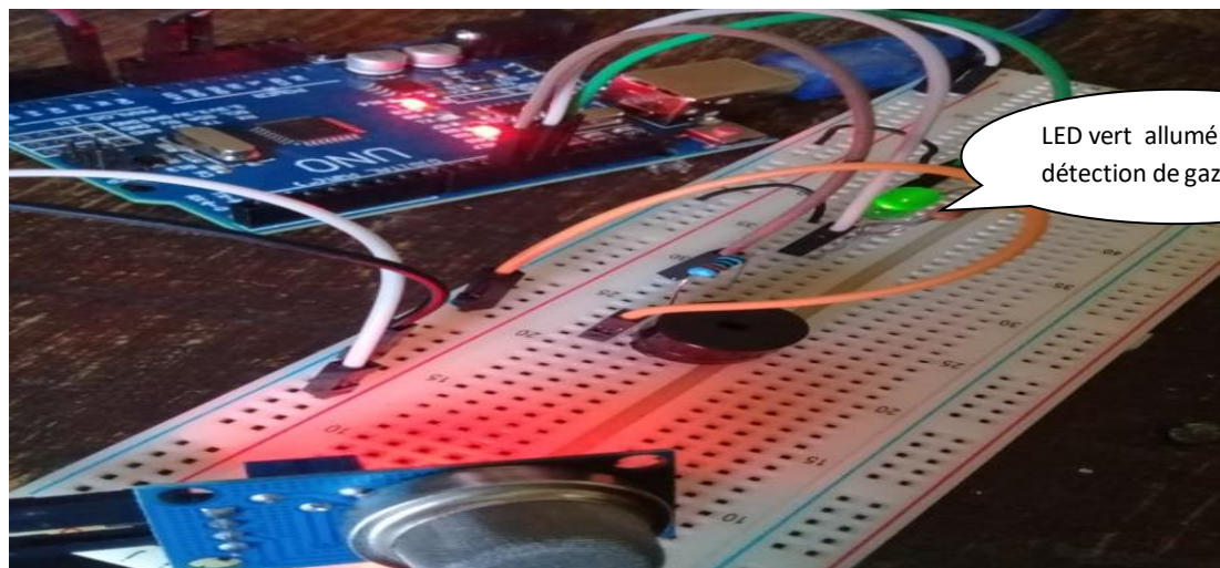
FigureIII.25 : Test de capteur de gaz cas d'aucune détection de gaze/fumé
