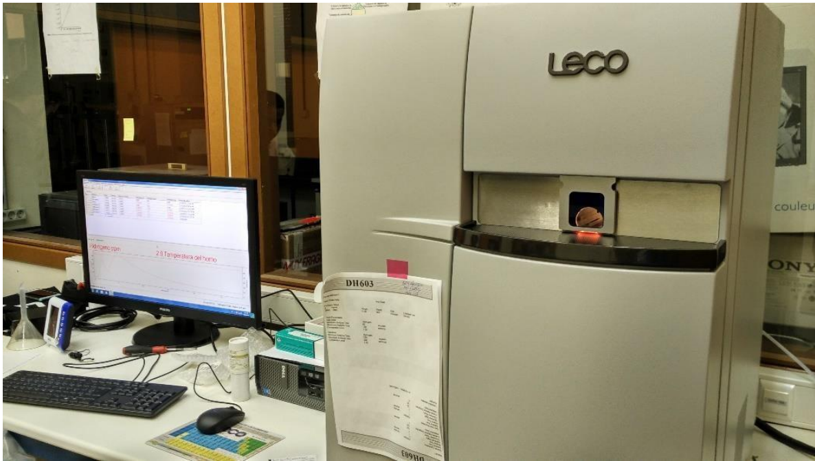
Figure IV. 3 Analyseur d'hydrogène LECO DH-603 utilisé pour mesurer la teneur en hydrogène
