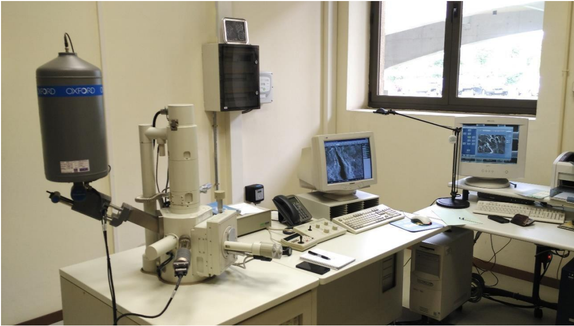
Figure IV. 1 MEB Equipement du microscope à balayage électronique JEOL-JSM5600
