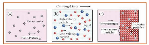
**Fig.1.9 :** Trois types de méthodes de fabrication des FGM sous la force centrifuge (A) Méthode centrifuge, (b) Méthode de bouillie centrifuge, (c) Méthode de pressurisation centrifuge (Y. Watanabe et al, 2011).
