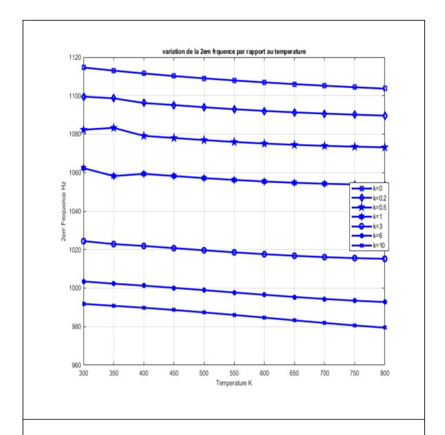
**Figure 3.6**: Influence de la température sur la  $2^{\text{ème}}$  fréquence propre de la barre cylindrique FGM pour divers volumes fractions
