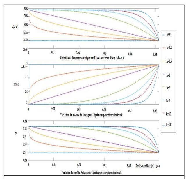
Figure 3.4 : Variation des propriétés FGM en fonction de l'indice k du volume fraction
