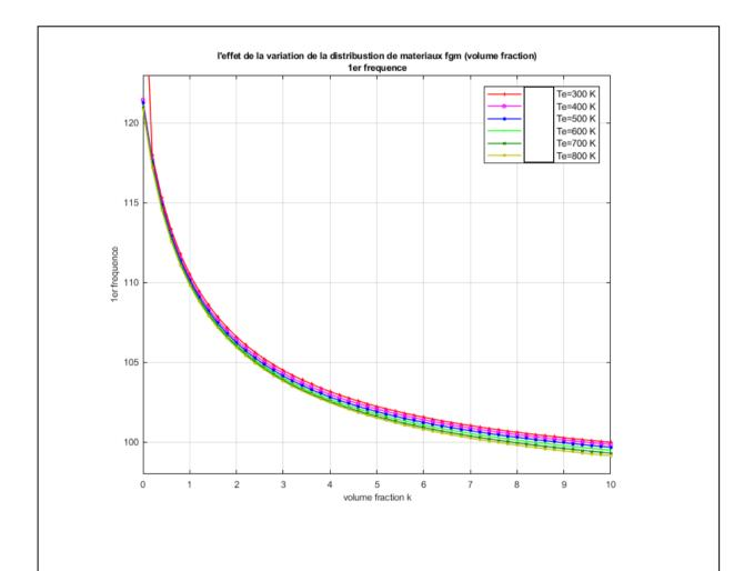
**Figure3.8 :** Influence de Indice k du volume fraction sur les fréquences propres de la barre cylindrique FGM pour divers températures (1<sup>ère</sup> fréquence).
