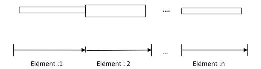
$\it Fig~3.3~$  Ligne d'arbre avec plusieurs éléments ayant des caractéristiques physiques et géométriques quelconques
