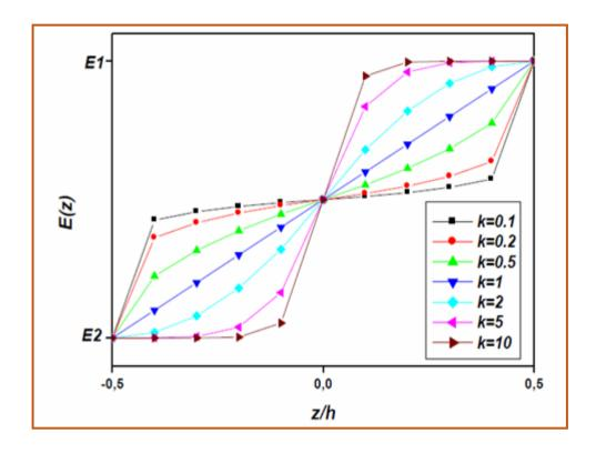
Fig.1.6: Variation du module de Young à travers l'épaisseur de la structure S-FGM
