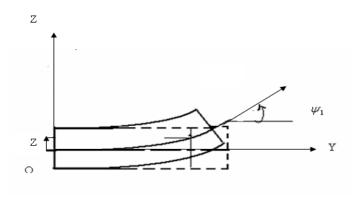
Fig2.5 déformation de l'arbre dans le plan ZOY
