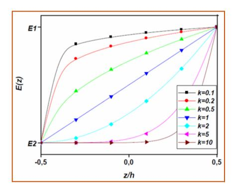
Fig.1.5: Variation du module de Young à travers l'épaisseur de la structure P-FGM
