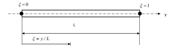
Fig. 2.3 Représentation d'un élément de poutre de type p
