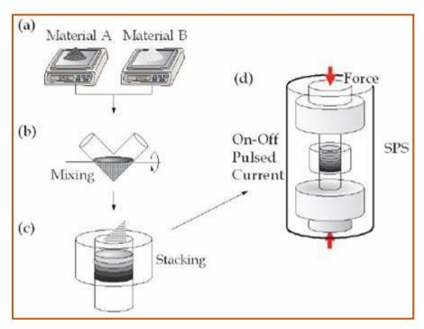
**Fig.1.8 :** Exemple de processus de fabrication typique de FGM par la méthode de la métallurgie des poudres. (Y. Watanabe, 2011)
