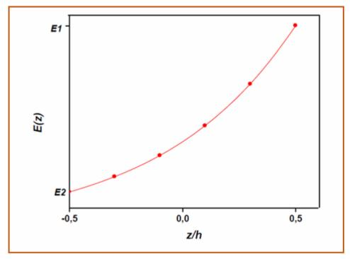
**Fig.1.7 :** Variation du module de Young à travers l'épaisseur de la structure E-FGM
