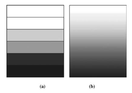
Fig.1.4 Modèle analytique pour une couche d'un matériau à fonctionnel gradues FGM
