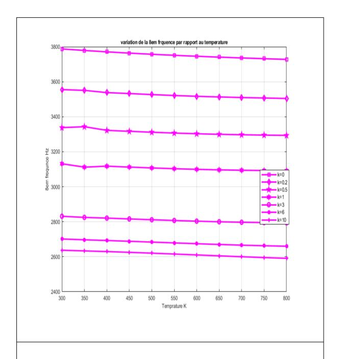
**Figure 3.7** : Influence de la température sur la  $8^{\text{ème}}$  fréquence propre de la barre cylindrique FGM pour divers indices k de volumes fractions
