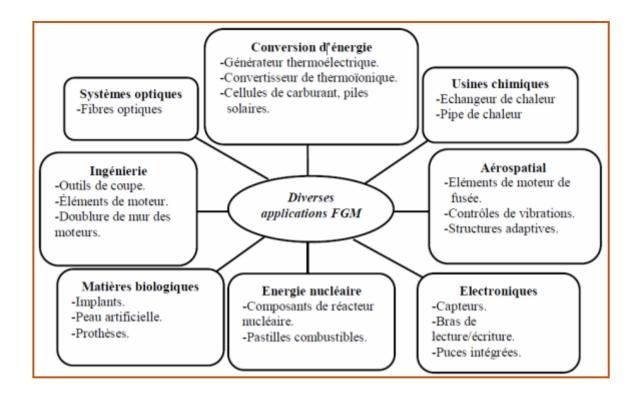
**Fig.1.10 :** Les principaux domaines d'application des FGM. (Bessaim, 2014)
