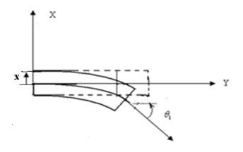
**Fig. 2.4** déformation de l'arbre dans le plan XOY
