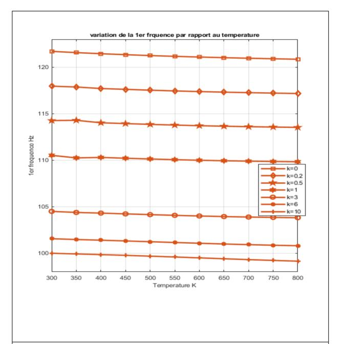
**Figure 3.5** : Influence de la température sur la 1<sup>ère</sup> fréquence propre de la barre cylindrique FGM pour divers volumes fractions
