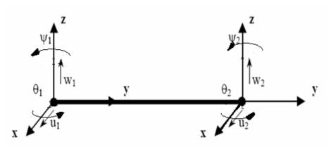
fig2.7 : Degrés de libertés d'un élément arbre
