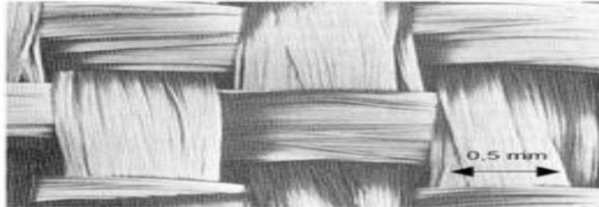
Fig. I. 5 : Microstructure vue au MEB d'un tissu de mèches avant imprégnation avec la résine.
