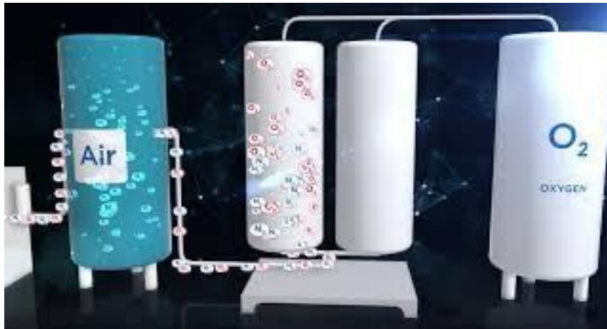
Figure II.3 : schéma d'un système PSA
