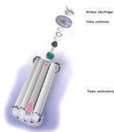
Figure II.5 : Décomposition du barillet du module ATF
