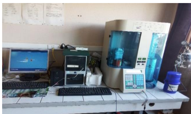
Figure II.6 : Appareil de mesure de la surface spécifique des matériaux « Nova1000 ».
