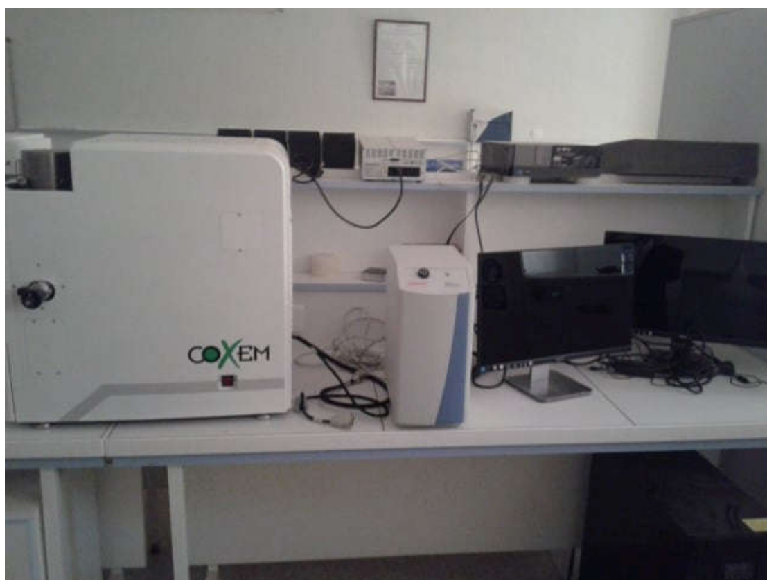
Figure II.8: Image de microscope électronique à balayage (coxem)-microanalyse EDS.
