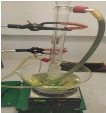
Figure 25: Synthèse de l'ester éthylique à partir de l'acide stéarique et Méthanol.
