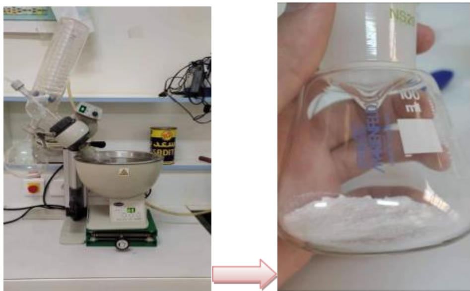
Figure 27: L'évaporation du solvant dans un rotavapeur.
