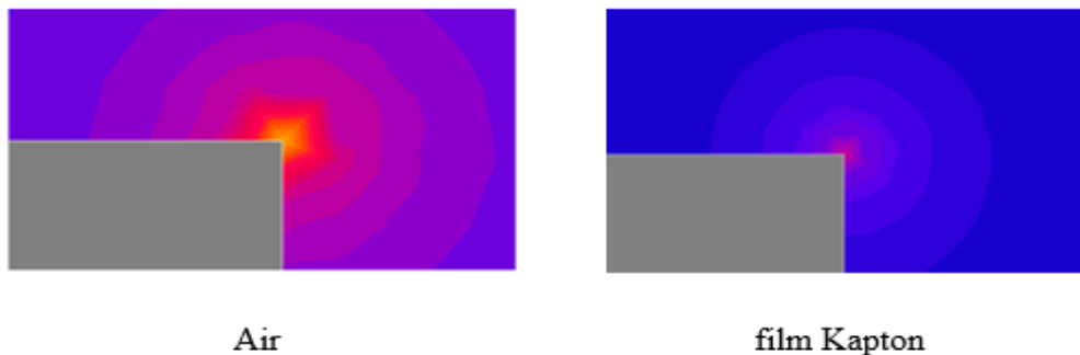
Figure IV.15 : Dégradé de champ électrique pour Air et film kapton (T1).
