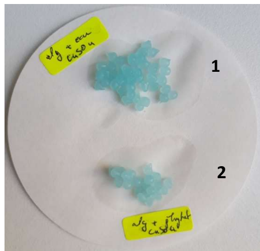
Figure 8: Test des capacités chélatrices de l'acide phytique avec les billes d'alginate.
