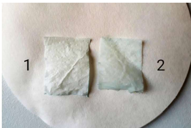
Figure 7: Test des capacités chélatrices de l'acide phytique avec du papier filtre.
