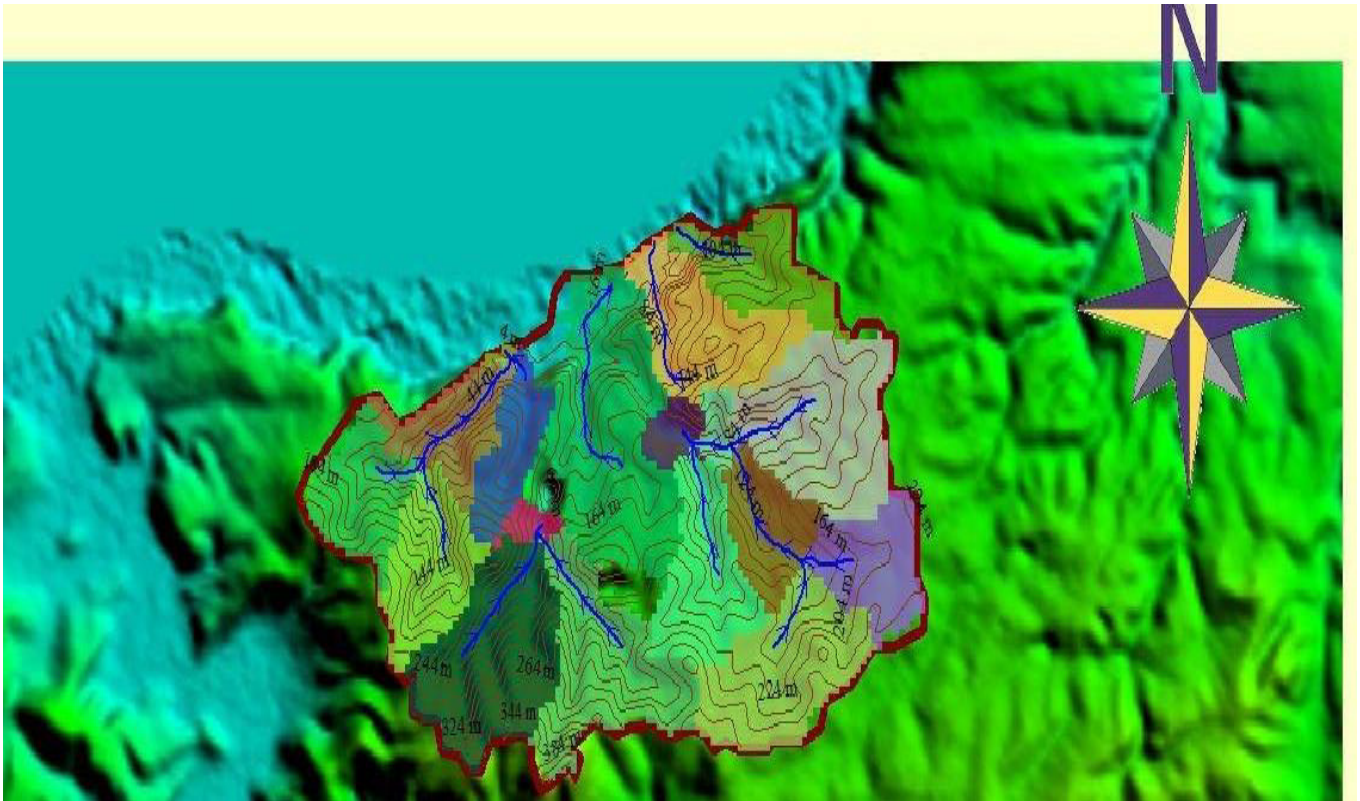
Figure N° IV.5 : Classification du réseau hydrographique du bassin versant
