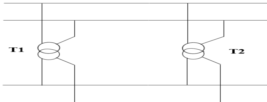
Figure III-11: Branchement en parallèle de deux transformateurs.[10]
