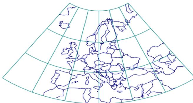
**Figure 43 : Projection conique conforme de Lambert. [42]**
