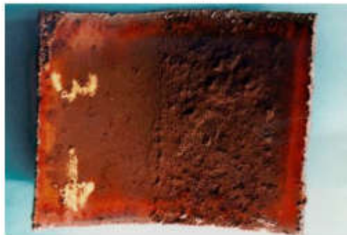
Figure I.14 : Corrosion interne dans la pipe
