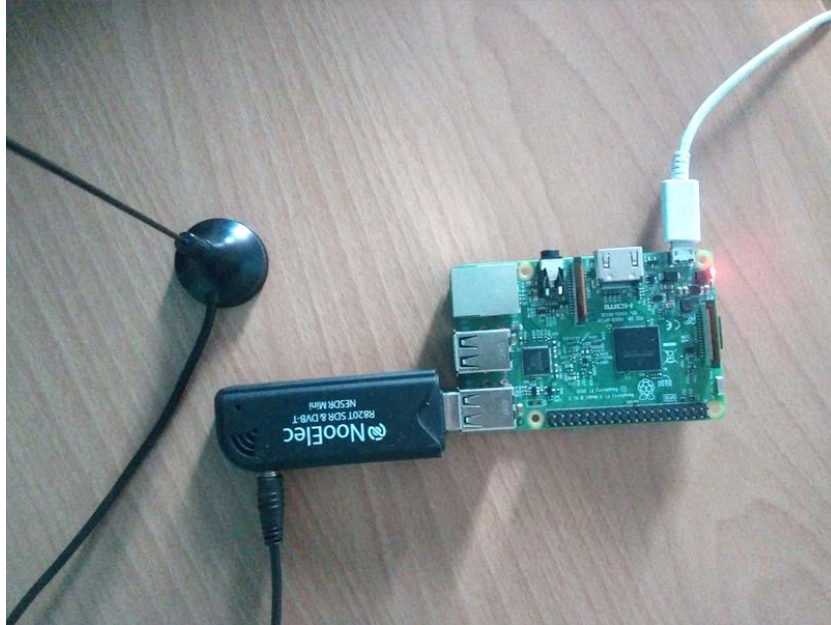
Figure 24 : La carte raspberry pi avec le dongle RTL-SDR.
