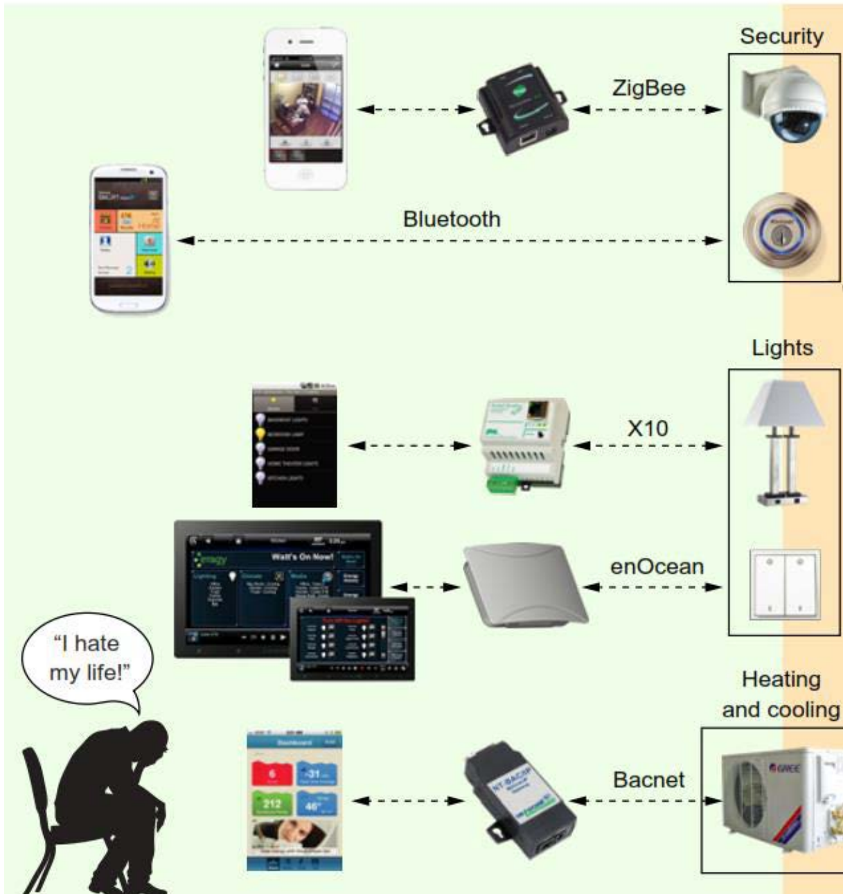
Figure 5 : Internet des objets avec différentes protocoles de communication [5].
