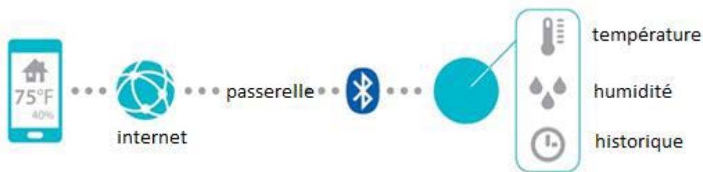
Figure 2 : Capteur de température et d'humidité connecté avec un smartphone via internet [7].
