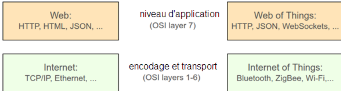
Figure 7 : la couche OSI et les protocoles de WoT.
