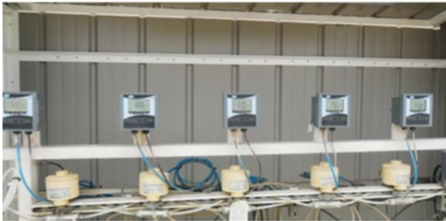
Fig. II.21. Appareillage de mesure avant l'entrée d'eau dans les châssis. [05]
