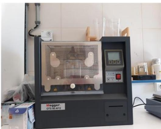
le MEGERR est pour la mesure de la tension de claquage d'huile de transformateur, on peut dire qu'il mesure le point ou cet huile être non isolant.
