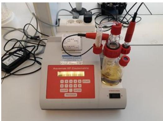
Le titrateur du KARL FISHER est pour la mesure d'humidité dans les huiles, avec deux réactif A et C il y'a une génération du courant par une cathode.
