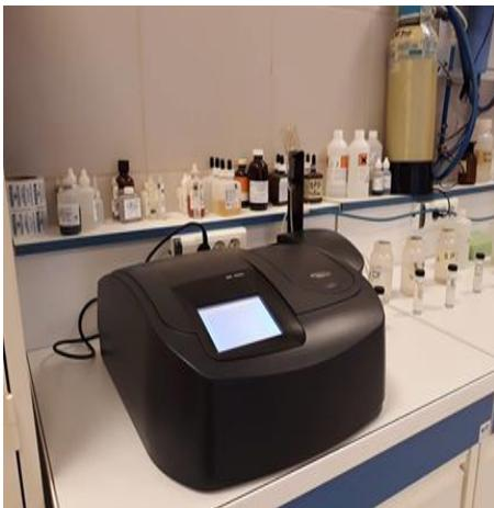
Le spectrophotomètre DR5000 : c'est un appareil permet analyser plusieurs paramètre contient deux lampe :
