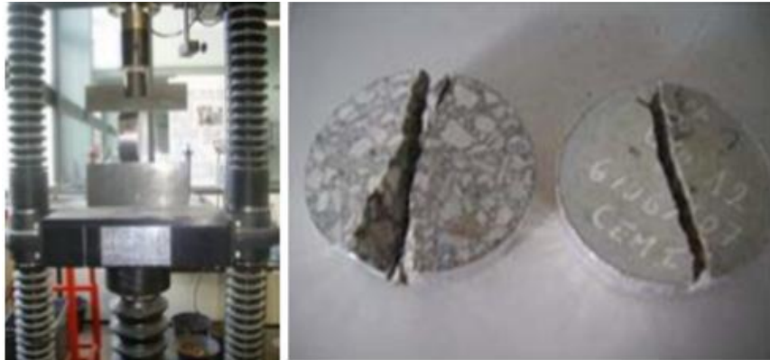
Fig.III-14 : Réalisation de l'essai de fendage brésilien. [16]
