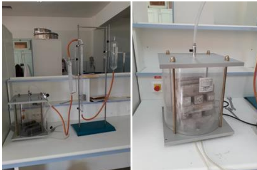
Fig.V-24 : Enceinte de la carbonatation accélérée.
