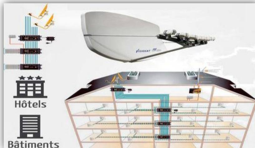
Figure 37: exemple de parabole collective
