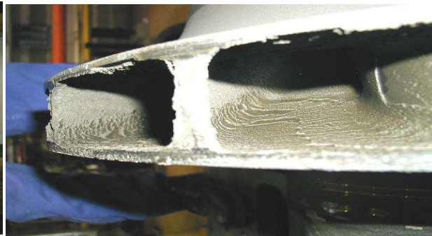
Fig .IV.10: Boue humide à l'intérieur de la roue
