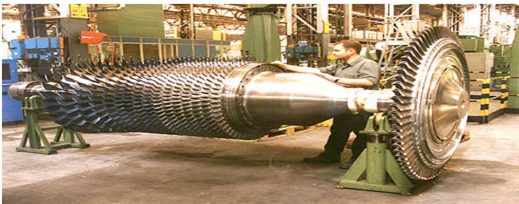
Figure I.3 : Rotor du compresseur de la turbine à gaz MS 5002C.
