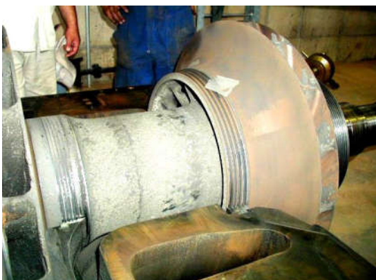
Fig. IV.13: Dépôt de boue sèche.
