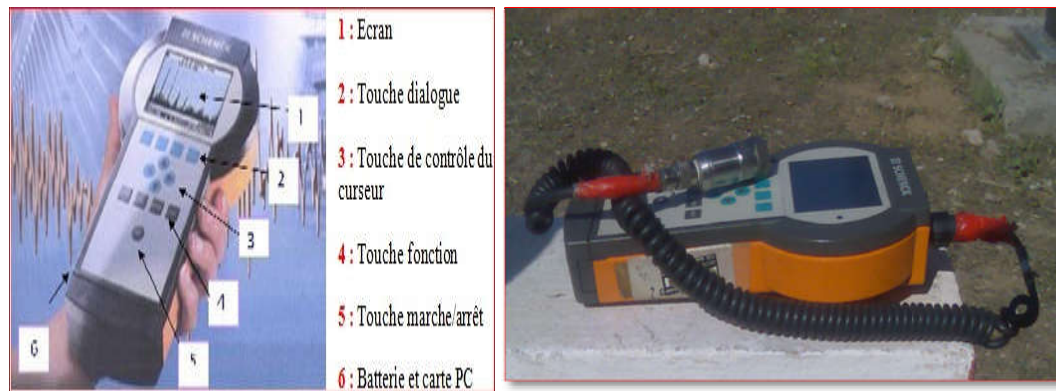
Figure II.1 : Appareil de mesure de vibration «VIBROTEST60 60 »
