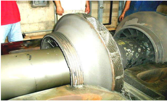
Fig .IV.9: Boue sur la roue.
