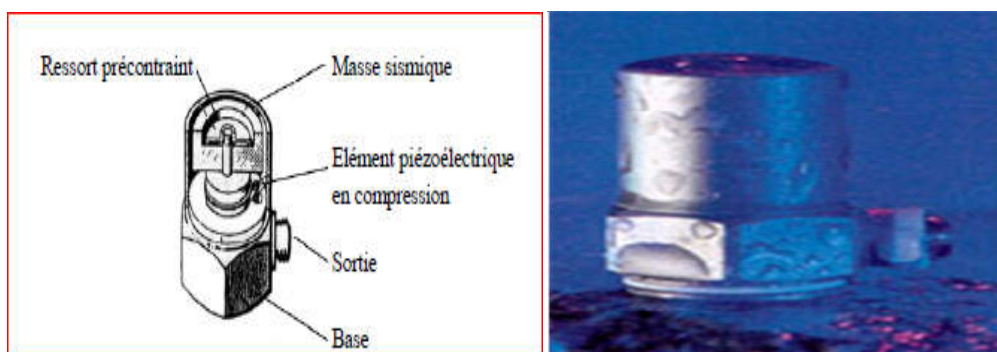
Figure .I .3: Accéléromètre piézoélectrique
