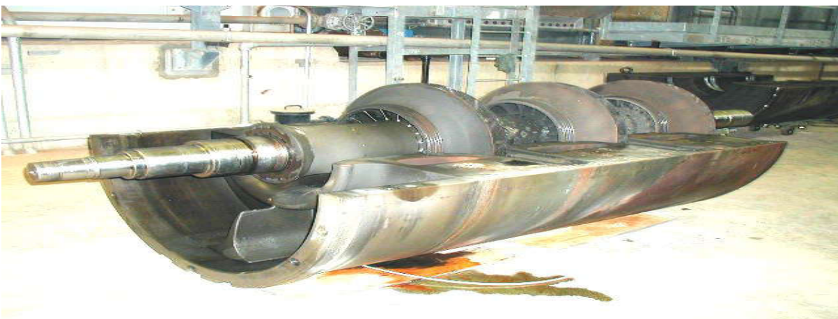
Figure .IV .8: Image du rotor après le démontage.
