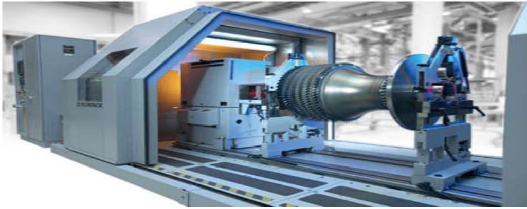
Figure. III .37 : Machine à équilibrer moderne pour une utilisation universelle
