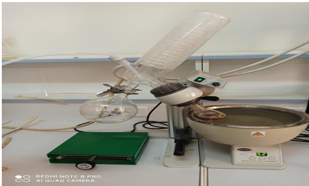
Figure n°7 : Evaporateur rotatif utilisé pour l'évaporation à sec de l'extrait aqueux de S. persica .
