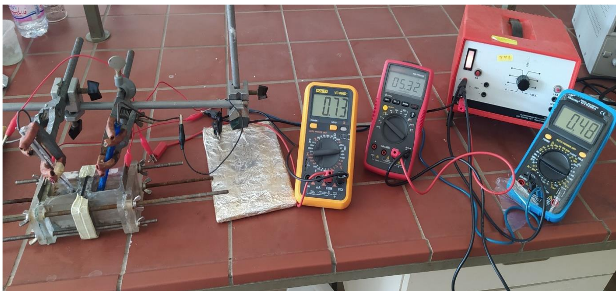
Figure II-4: Dispositif expérimental pour la détermination des courbes courant-tension
