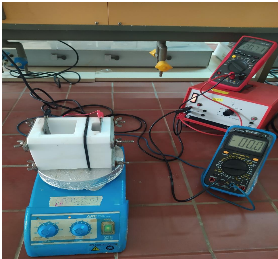
Figure II-2 : Dispositif expérimental pour la détermination du nombre de transport
