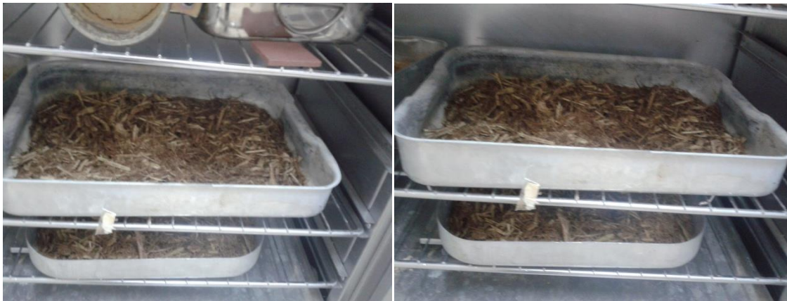
Figure 20 :-Déshydratation dans une étuve pendant 24 heures avec une température de 105°C.
