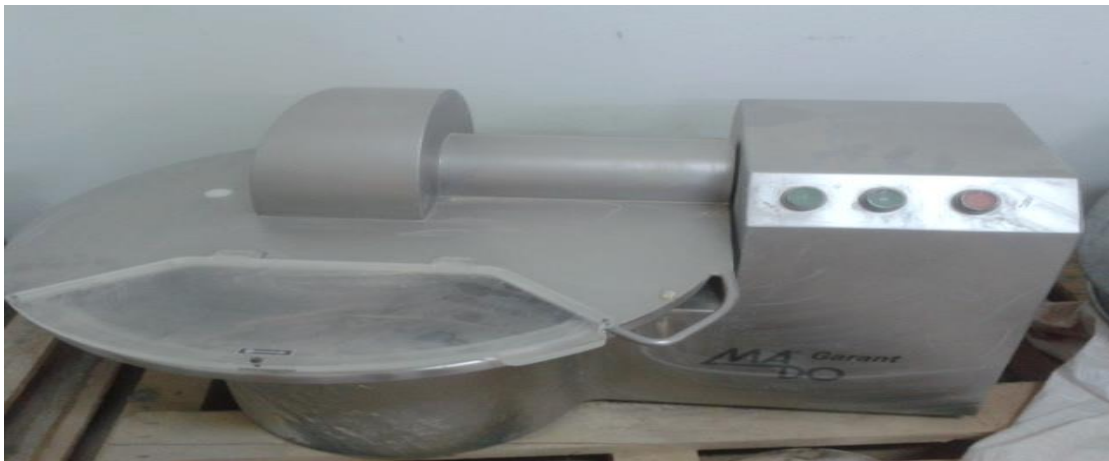
Figure 21 : Broyage avec un cutter de laboratoire
