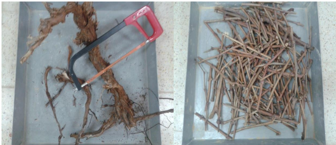
Figure 19 : Dénichée de l'écorce du bois et découpage avec une scie.
