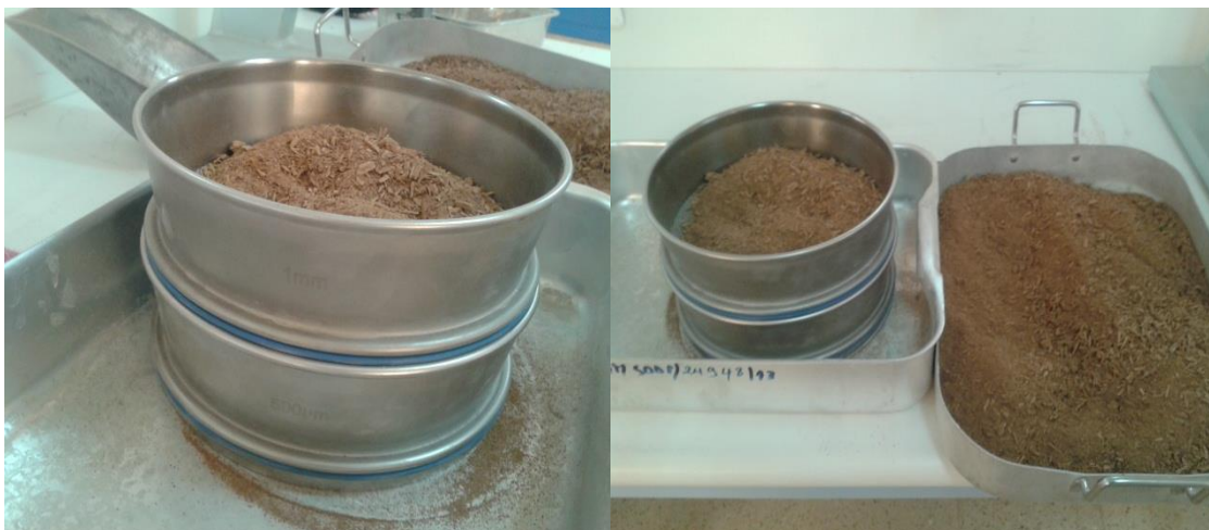
Figure 22 : Tamisage avec un tamis de diamètre de 1mm
