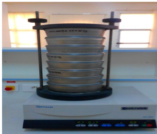
Figure24 : Tamis-vibreur (Fond, 45 \mu m,63 \mu m,80 \mu m,125 \mu m,250 \mu m,500 \mu m et 1 mm).
