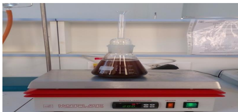
Figure 25 : Pycnomètre est porté à ébullition pendant au moins une 1h.
