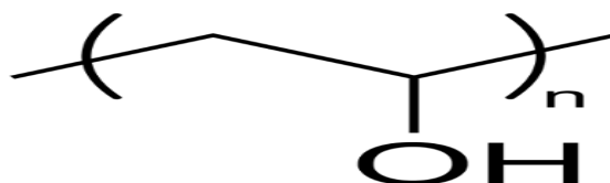
Fig09 : structure de l'alcool polyvinylique
