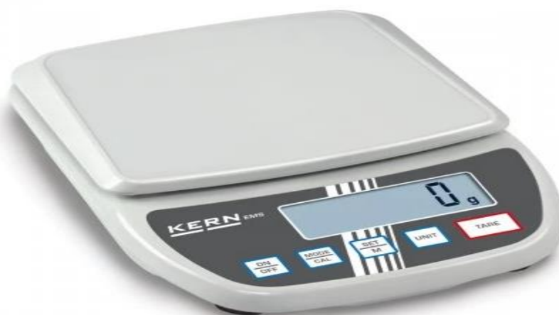
Figure II.5 : Balance de laboratoire électronique
