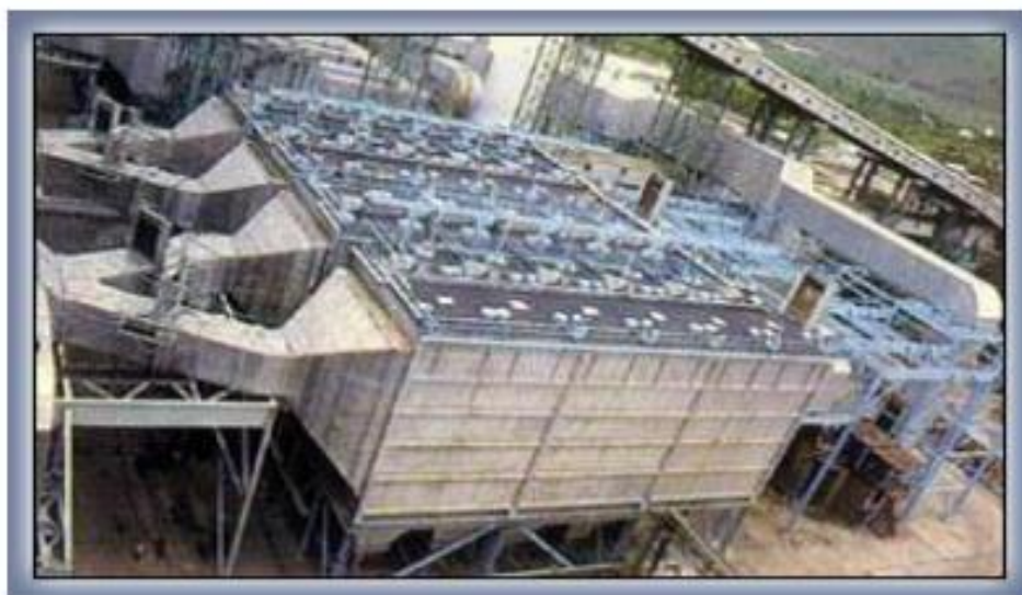
Figure I.10 : photographie d'un précipitateur électrostatique
