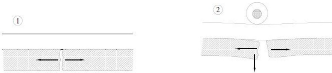
Figure I.19: Mode I : Retrait thermique ; Mode I+II : Passage des charges de véhicule
