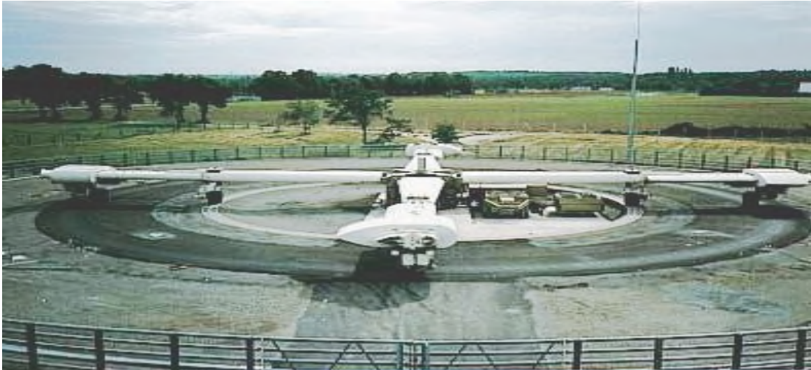
Figure I.15: Manège de fatigue du Laboratoire Central des Ponts et Chaussées à Nantes
