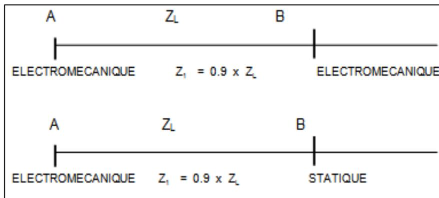
Figure IV-5 : Schémas de réglages de zones de mesures [34].
