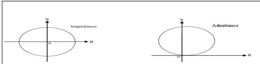
Figure III-10 : Caractéristiques de fonctionnement du relais à distance [24].
