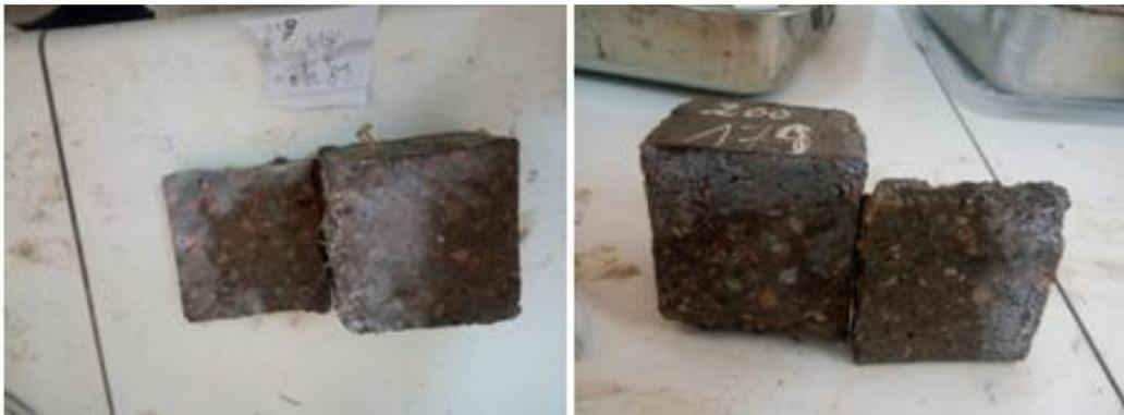
Figure 4.33 Mesure de la profondeur de pénétration des ions chlorures.
