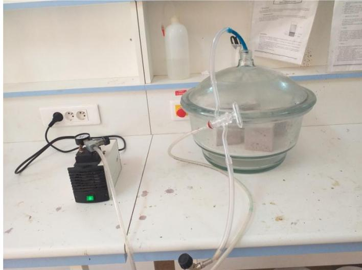
Figure 4.24 L'essai de porosité.
