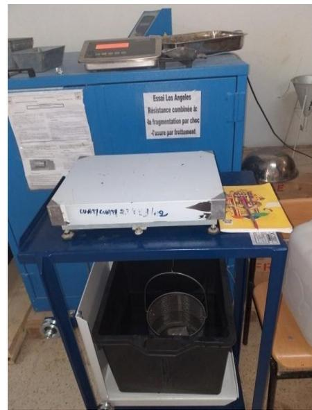
Figure 4.26 Principe de la pesée hydrostatique
