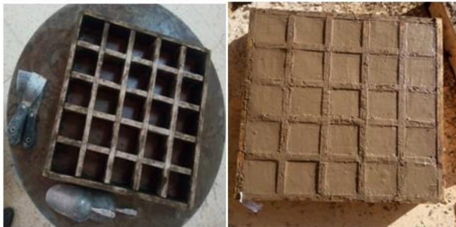
figure 4.17 la table vibrante et les moules pour éprouvette de 7\*7\*7cm<sup>3</sup>.
