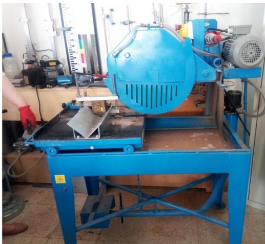
Figure 4.30 machine de Scie a béton.
