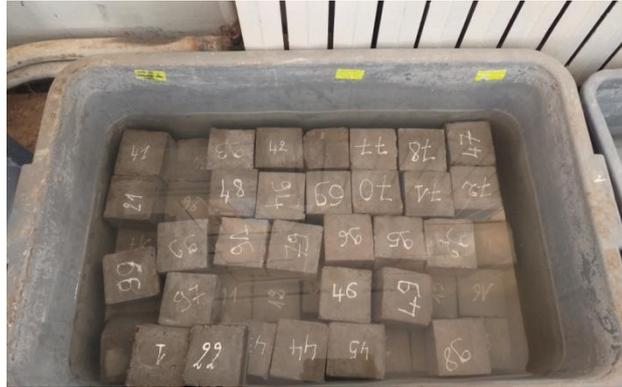
Figure 4.18 conservation des éprouvettes dans Léau a  $20 \pm 2$  °C.
