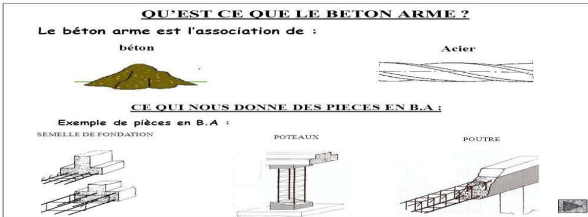
Figure 1.7. Les composants du béton armé et les pièces ce que nous donne [9].
