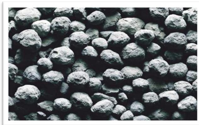
Figure 1.1 le clinker le constituant principale du ciment[4].
