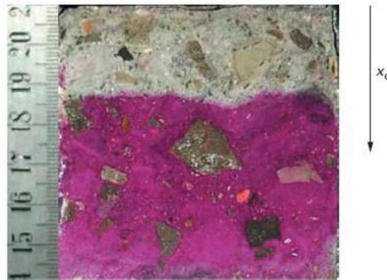
illustration de la méthode d'évaluation de la profondeur carbonatée  $x_c$  à l'aide d'un indicateur coloré (phénolphtaléine)
