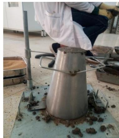
Figure 4.19 Mesure de L'affaissement au cône d'Abrams.
