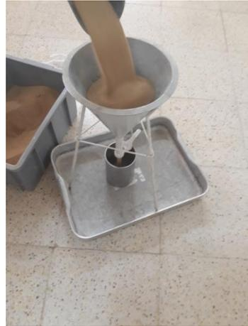
Figure 4.13 Entonnoir et récipient de mesure
