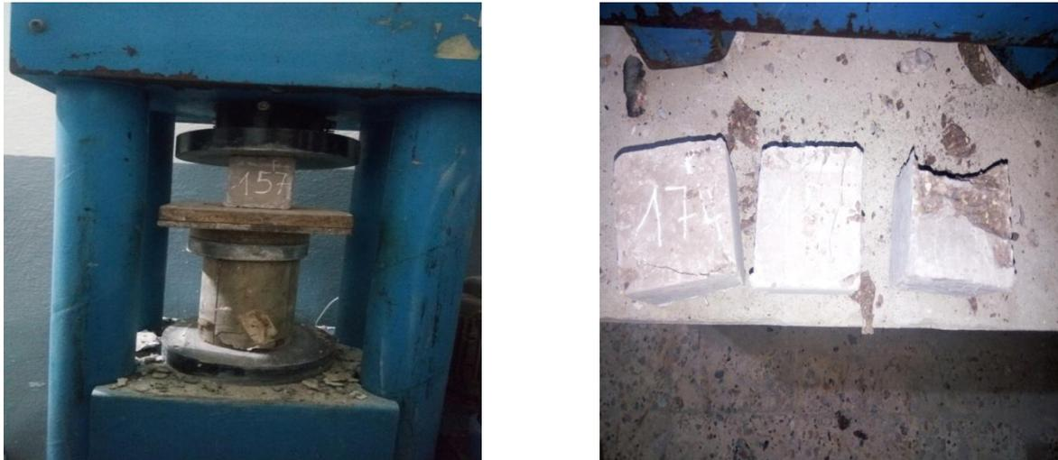
Figure 4.22 Ecrasement des éprouvette ( $7*7*7 \text{ cm}^3$ )
