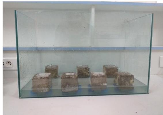
Figure 4.28 Essai de diffusion. Immersion de la face inférieure dans la solution de contact de NaCl.
