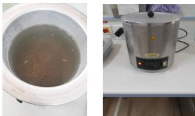
Figure 4.15 Coefficient d'absorption de gravier 3/8
