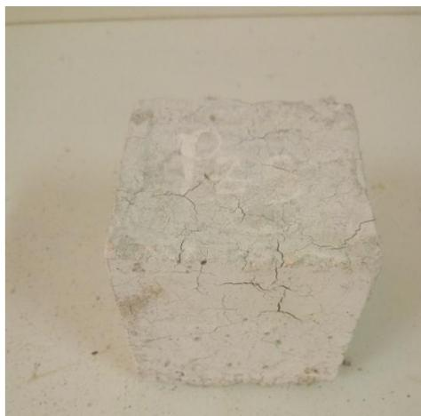
Figure 4.20 les fissures du béton pz pour un chargement thermique de 900°C.
