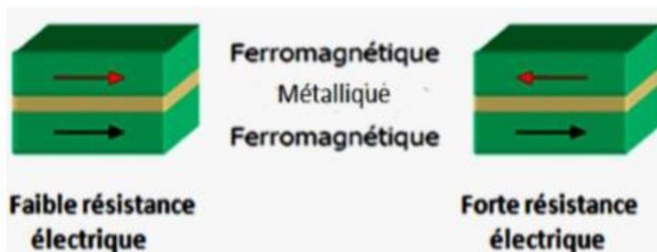
**Figure I.11** : les deux états, parallèle et antiparallèle, dans une jonction géante magnétique.
