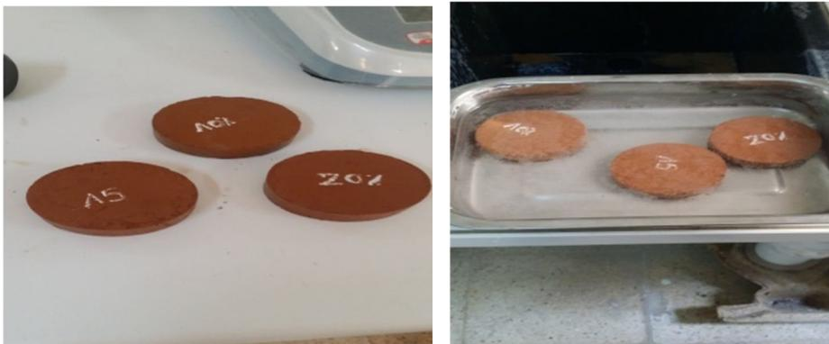
**7-1 Essai d'absorption à eau :**
