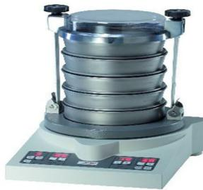
Figure 5 : Analyse granulométrique
