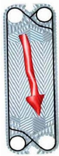
Figure II.9: La circulation des fluides est diagonale [6].
