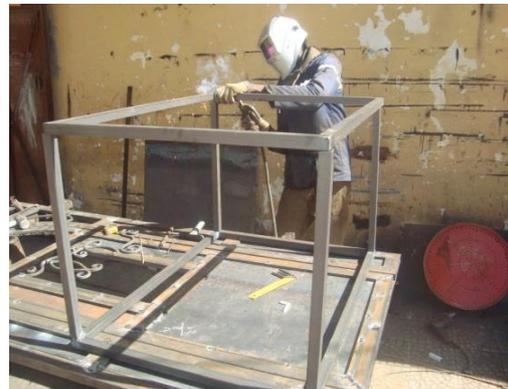
Figure III.7. Le forgeron soudé la table
