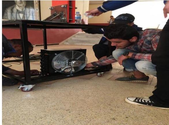
Figure III.11. Fixé les échangeurs de chaleur
