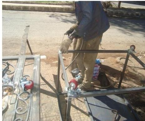
Figure III.9. Le forgeron soudé les rouleaux
