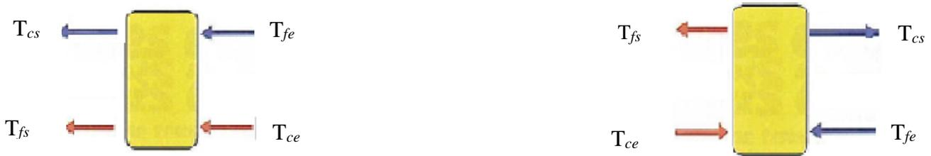
Figure III.13.Schématisation des fonctionnements à co-courant et contre courant
