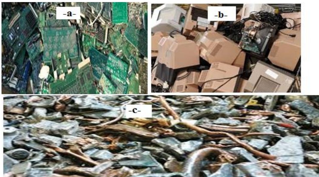
Figure I-5 :-a- Cartes électroniques extraites des DEEE -b- Coques plastiques de télévision avant broyage pendant le traitement -c- Fractions métalliques issues du recyclage des DEEE .[4]
