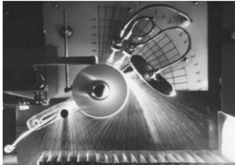
Figure I-13 : Trajectoire réel des particules dans un séparateur a cylindre tournant [5]
