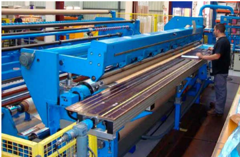
Figure II.6: Réalisation du corps condensateur d'une traversée [ 12].
