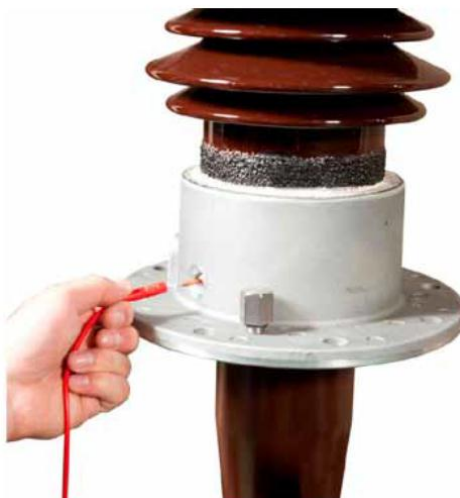
Figure II.11 : Prise de mesure de capacité et tan delta
