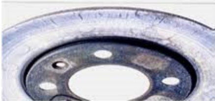
Figure IV-8 : Faïençage sur les pistes de frottement
