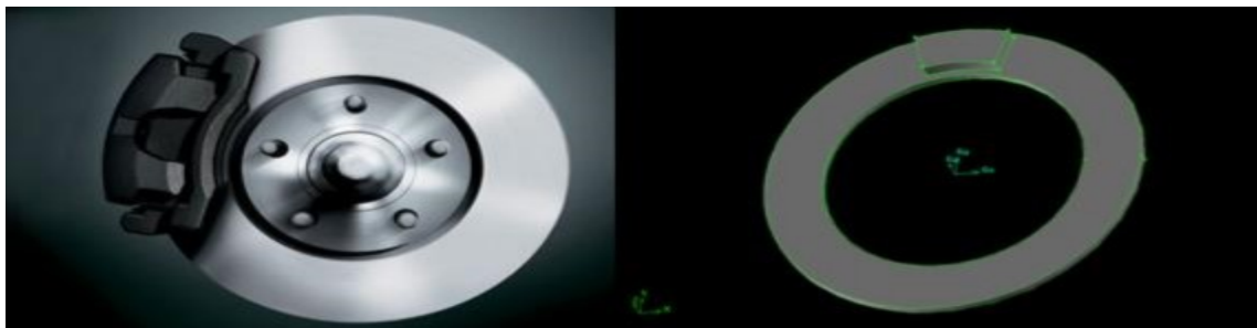
Figure à gauche disque de frein réelle et à droite disque de frein modélisé
