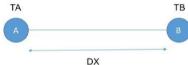
Figure III-2 : définition du gradient thermique.
