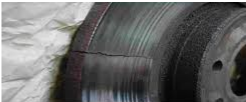
Figure IV-8 : Faïençage sur les pistes de frottement
