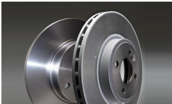
Figure II-9 : Disque ventilé et disque plein
