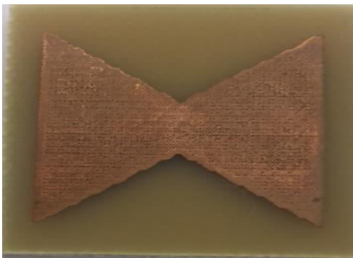
Figure II-19 Prototype de l'antenne patch papillon miniaturisée avec l'ajout de courts-circuits
