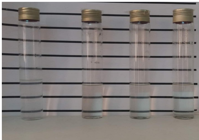
Figure 6: Comparaison visuelle entre la turbidité du McFarland 0,5 et la turbidité des 3 souches de référence.
