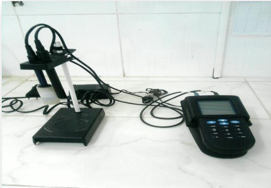
Figure 9 : Multi paramètre (température, pH, conductivité, salinité, taux des sels dessous, oxygène dessous, potentiel redox).
