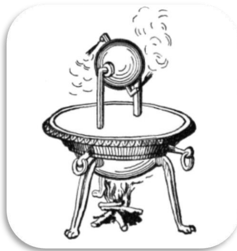
Figure I-01: L'éolipyle de Héron d'Alexandrie [1]
